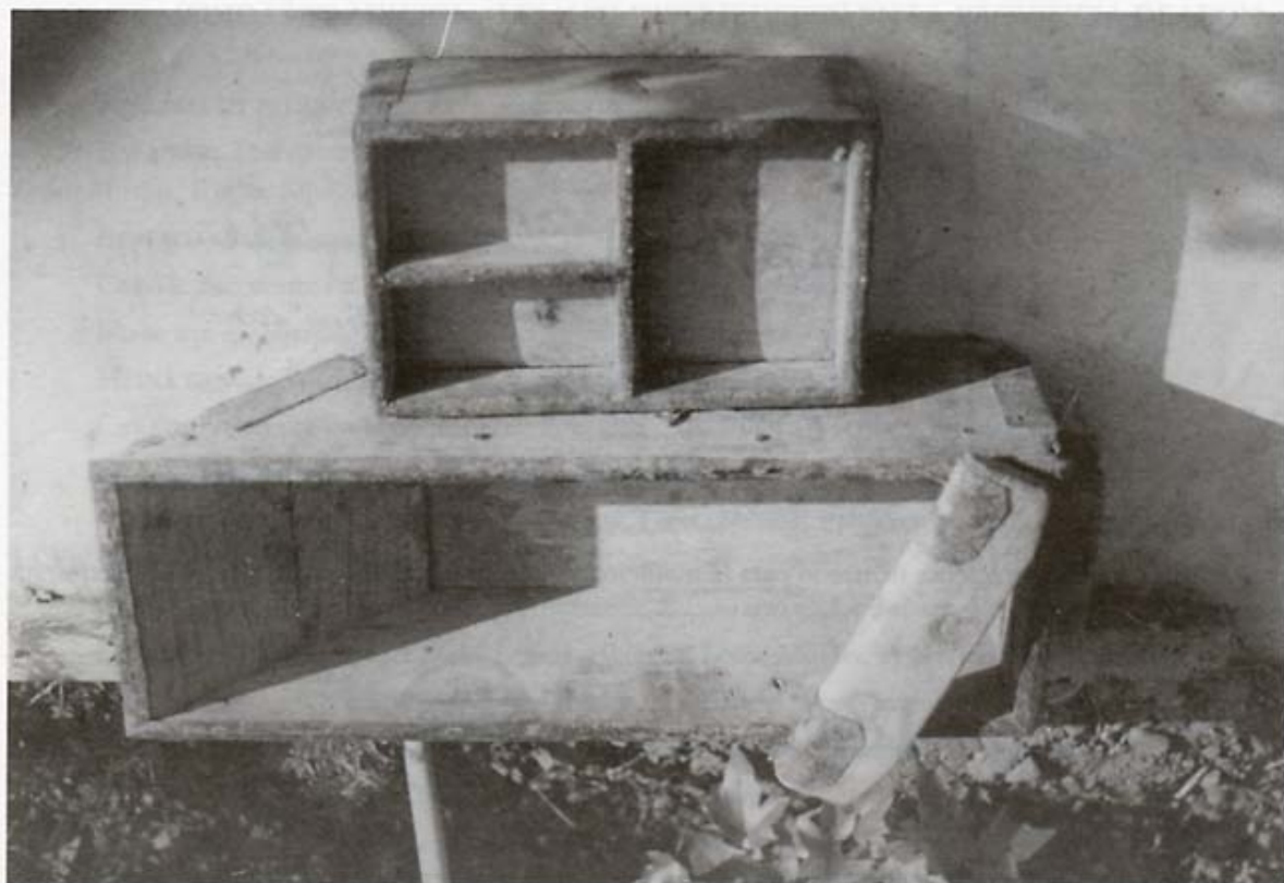
La muela-corta, dos separadoras. A) la que se emplea para separar el grano de la muela.
